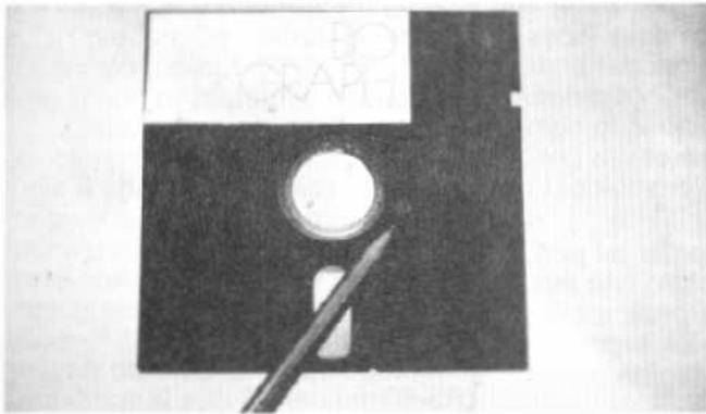
Foto 1 - Um disquete de face simples, com apenas um orifício e uma ranhura de cada lado
